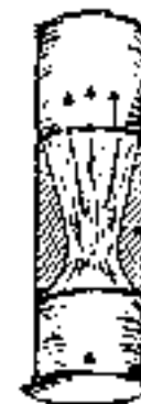
Fig. 3.42 De vernauwing in de carburateur heet: venturi.
