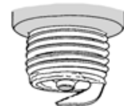
Fig.3.11 Een versleten massa-elektrode van een bougie.
