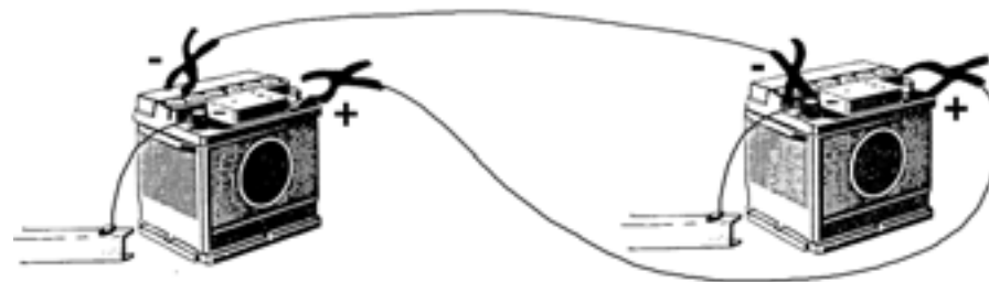
Fig. 2.35 Starten met een hulpaccu en hulpstartkabels.
